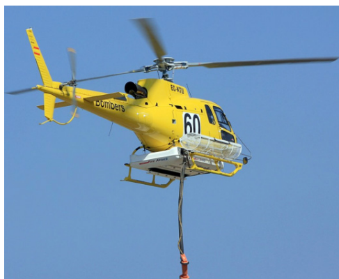
Figura 29. A-032/2012 - Conjunto de helicóptero y sistema de extinción Simplex 310
