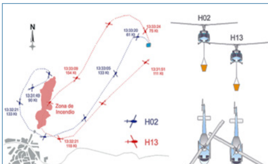
Figura 15. A-037/2011 - Trayectorias previas al impacto y posición de las aeronaves justo antes del impacto de la primera pala
