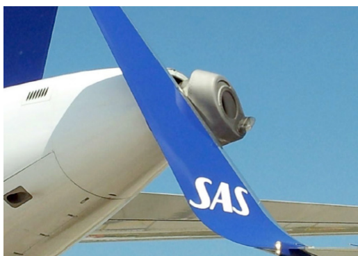
Figura 13. IN-033/2011 - Detalle del “winglet” del B-737 enganchado a la tobera de salida de gases del APU del A-320
