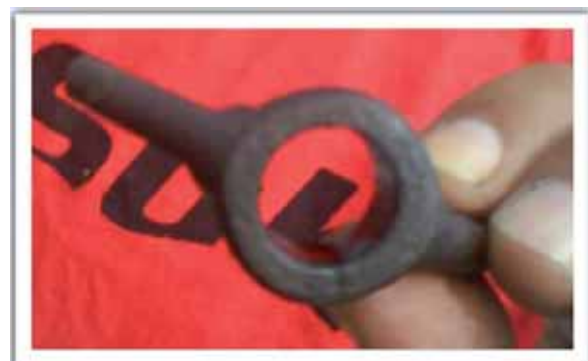
Figura 37. Estado de las palomillas de cierre de la tapa de proa del tanque número 1 de estribor
