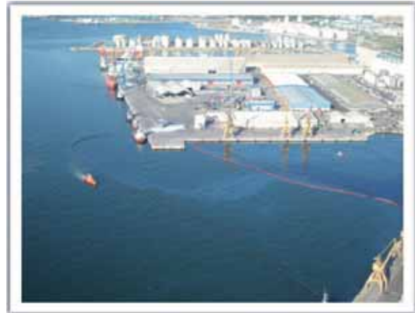
Figura 40. Barreras de contención
