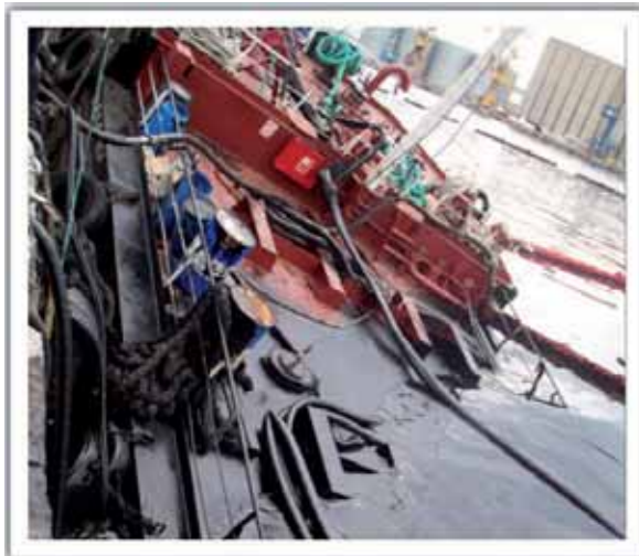
Figura 43. Tapa de proa del tanque número 1 de babor fuera del agua, con la válvula para introducir aire instalada
