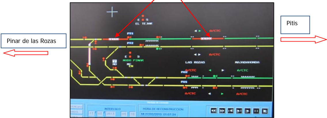
Circuitos de vía ocupados por los trenes de trabajos T1 y T2
