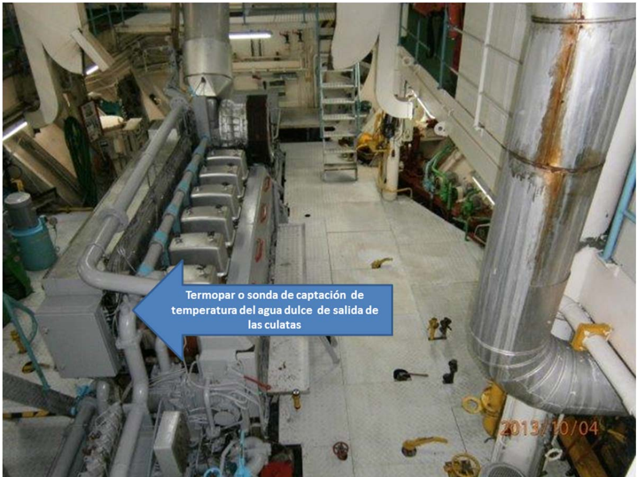
Figura 4. Emplazamiento del sensor cuyas lecturas originaron la alarma por alta temperatura y posterior parada del MP.
