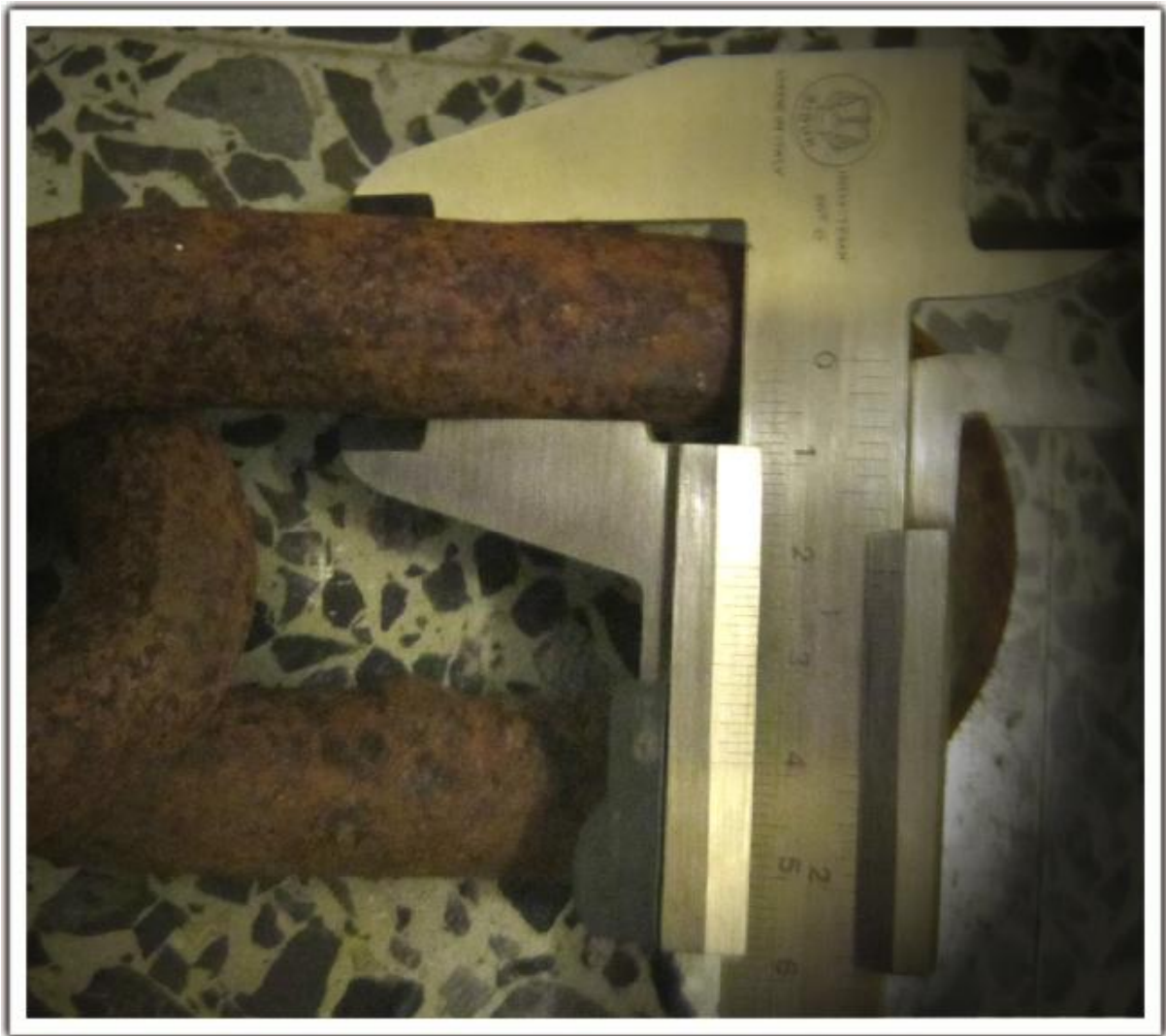
Figura 8. Eslabón de 20 mm, medido con pie de rey
