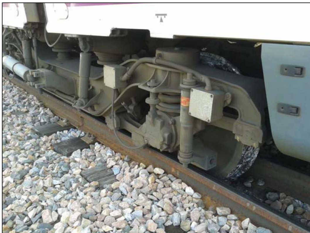
Segundo bogie descarrilado. Fuente Renfe Operadora.
