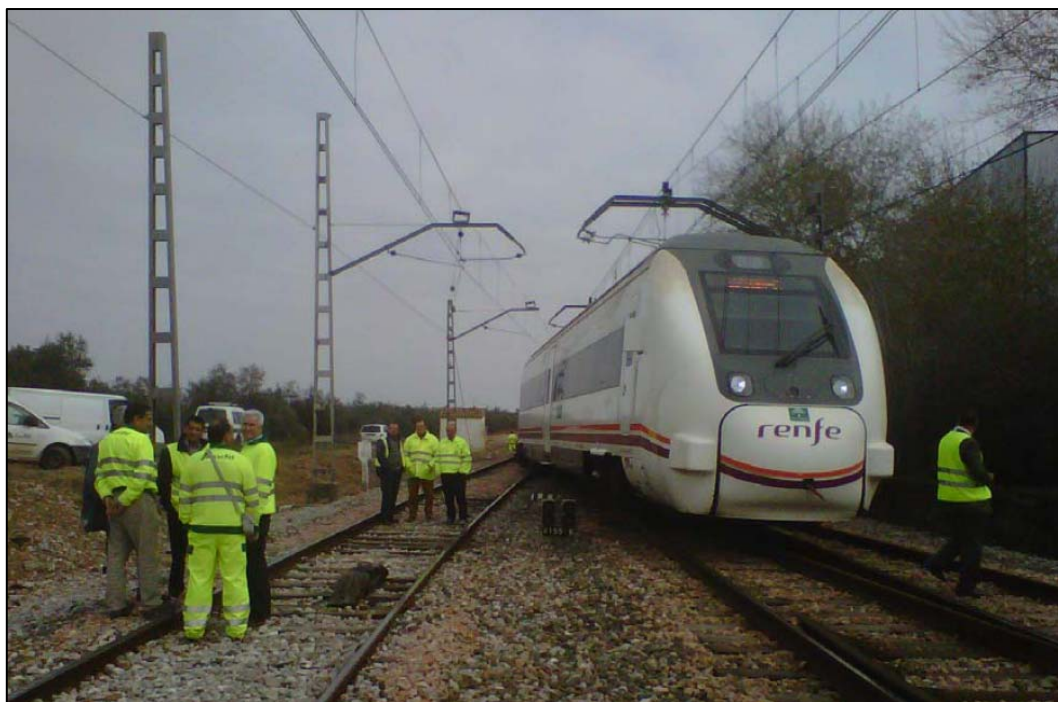
Automotor 449.037 descarrilado en la aguja nº 2. Fuente Adif.
