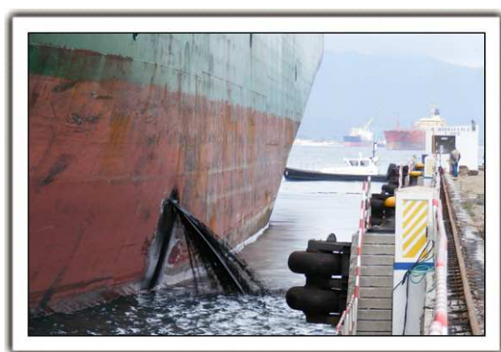
Figura 3. Brecha en el costado de babor a la altura del tanque almacén de fuel oil n.º 3
