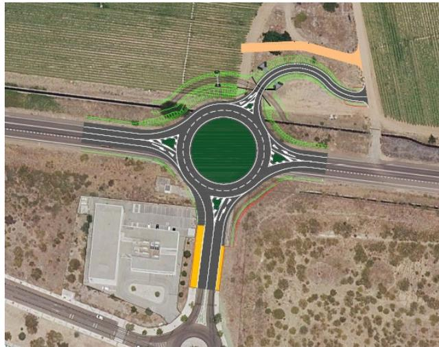
Para la mejora de la seguridad vial, se procede igualmente a reordenar los accesos mediante la anulación del existente en las proximidades de la glorieta proyectada y su reposición a través de la misma.
