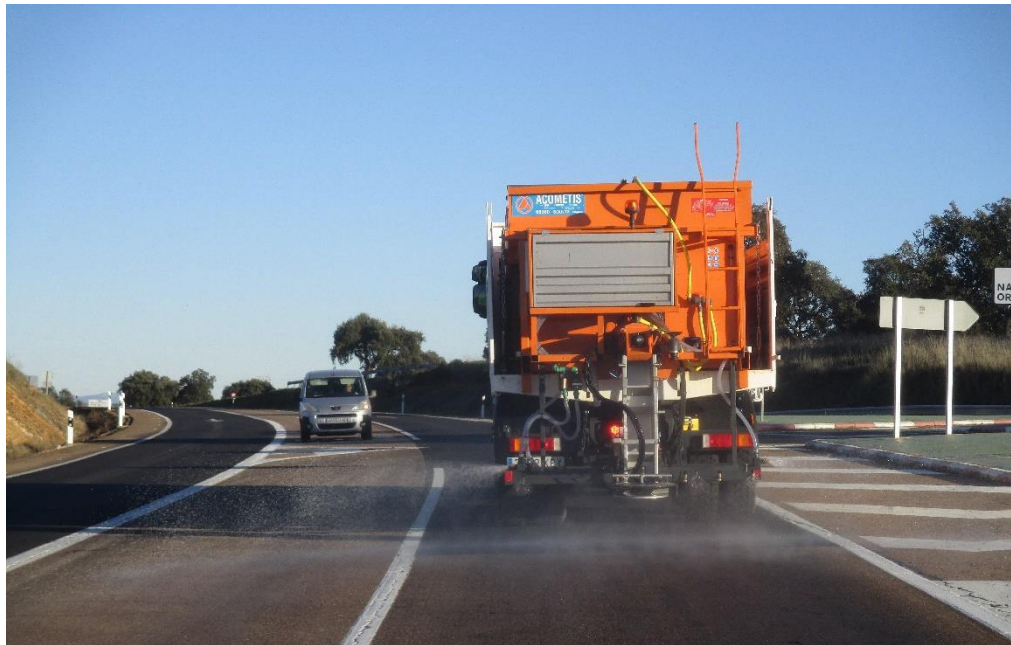
Extendido de fundentes. N-430, km 145,5
