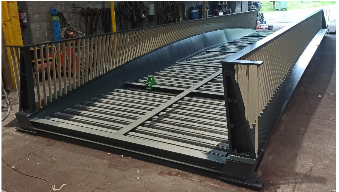
Pasarela peatonal en el taller de fabricación
