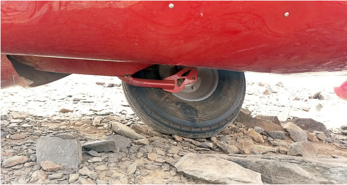
Figura 3. Daños en la pata de morro
