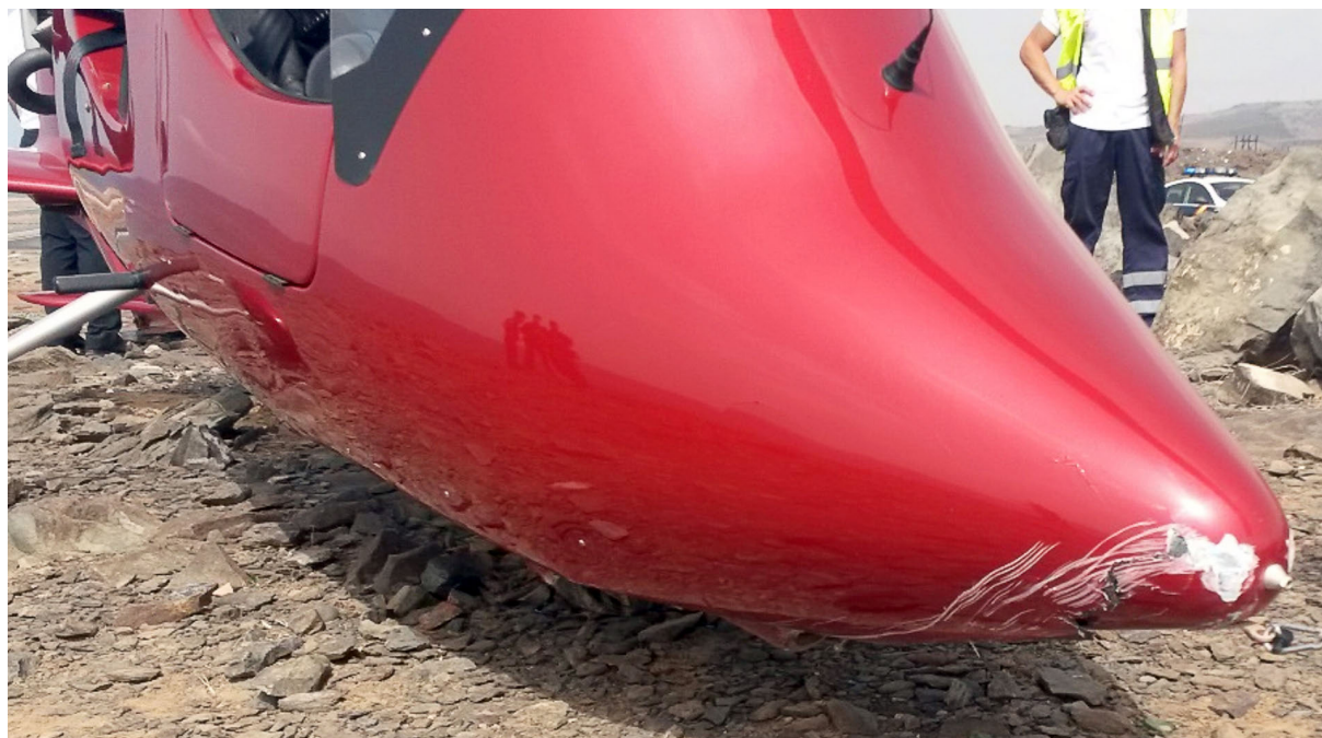
Figura 2. Daños en el carenado
